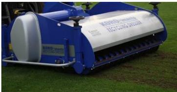
La Recycling Dresser airea el subsuelo vertical y horizontalmente. Elimina del suelo la capa de enraizamiento y lo distribuye sobre la superficie de juego. Elimina la estratificación y la compactación.
