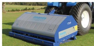
El Imants ShockWave es un descompactador lineal diseñado para revitalizar zonas muy estropeadas aliviando la compactación del suelo, lo que mejora la aireación y elimina el agua superficial.
