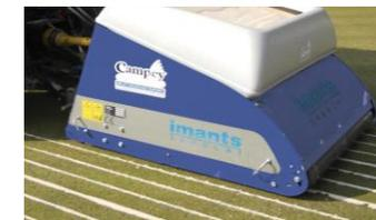
El Imants SandCat se mueve con ligereza sobre el césped, creando hendiduras en la superficie e introduciendo arena para facilitar el drenaje y mejorar las propiedades de la capa de enraizamiento.
