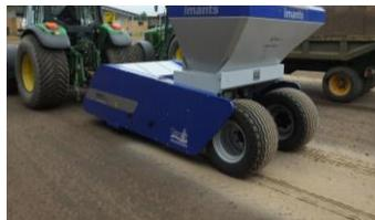
La TopDrain 1000 es una máquina multifuncional única que abre zanjas, retira la tierra excavada, inyecta arena y recompacta en una sola operación.
