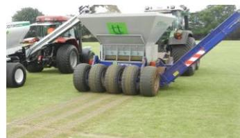
La TOPDRAIN 1500 es una máquina multifuncional que zanja, remueve la composición, inyecta arena y descompacta, todo en una pasada, produciendo un drenaje superficial completo.
