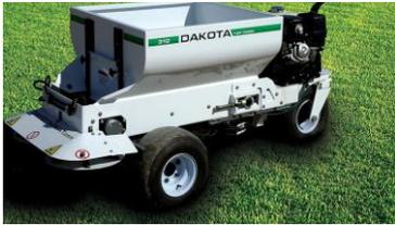
La Dakota 310 es una recebadora compacta, muy maniobrable y con doble disco giratorio, para ser operada a pie. Puede esparcir hasta 6 metros de anchura con ajustes infinitamente variables mediante mandos en el manillar.
