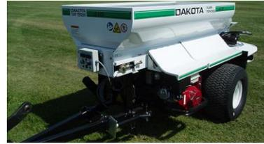
La Dakota 410 puede trabajar con material húmedo o seco, permitiendo recibos ligeros y pesados, y puede cargarse fácilmente con una pala de tractor de 1,8 m de ancho.
