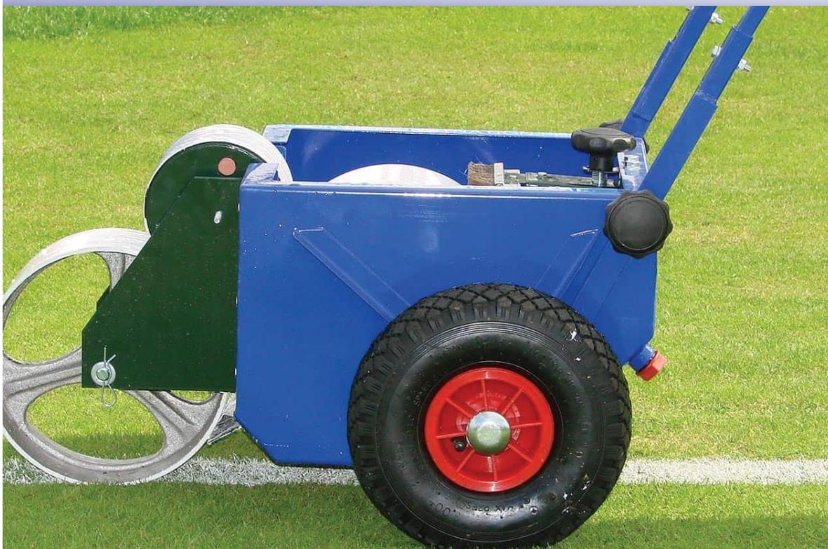
El RAYCAM™ LM3010 es un trazador de línea de transferencia con líquido, sencillo, duradero y fácil de usar. La pintura se transfiere de la tolva de 30 l a la rueda de trazado de 10 cm o 12 cm mediante una rueda de caucho acanalada que proporciona líneas uniformes y precisas.
