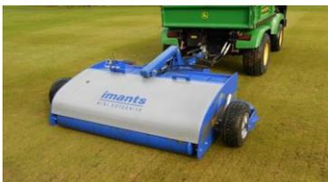
La Imants Mini RotoKnife es una aireadora lineal de discos diseñada para aliviar la compactación superficial, mejorar la aireación, reducir el crecimiento del colchón y eliminar el agua superficial.
