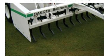
Dakota fabrica una gama de niveladoras remolcadas por tractor para mover y nivelar la tierra y la arena.
