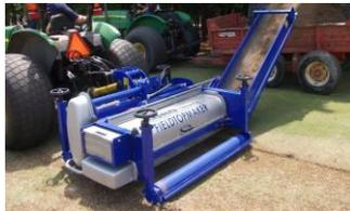
El KORO FIELDTOPMAKER tiene una cinta elevadora que elimina los restos directamente en un remolque. Se ha introducido una nueva cinta transportadora y el peso de la máquina se ha reducido mediante un transportador extraíble de 100 k.
