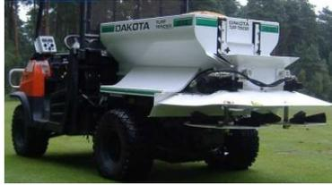
Especial para arena, mantillo, turba, abono y grava. Ideal para greens, apta para cualquier parte del campo. Cinta transportadora con salida trasera y con una construcción muy robusta.
