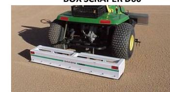
Niveladora para construcción y moldeo. La niveladora ligera D60 está diseñada para instalarse tras los rastrillos para búnkeres. Es ideal para mover y moldear pequeños volúmenes de material y para la nivelación final de la superficie.
