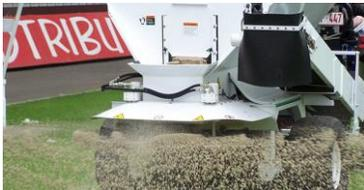
La Dakota 420 es una recebadora de tamaño medio con una calibración precisa y fácil de usar. La 420 está equipada con cuatro neumáticos Ultra Trac tolva de gran capacidad, cinta transportadora lateral de montaje frontal y anchura de recibo de 13 m con el sistema de doble disco giratorio. Mandos totalmente eléctricos/hidráulicos.
