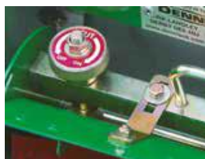
Ajuste sencillo de la parte inferior de la hoja al cilindro
