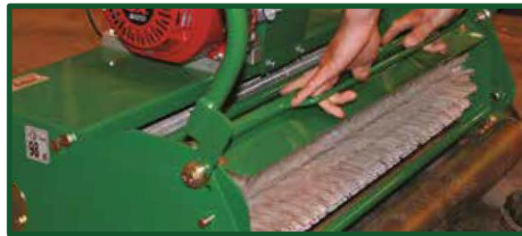
Inserte un nuevo casete en el perno del cojinete de la unidad delantera
