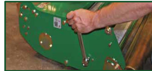
Apriete el perno de retención
