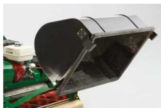
Punta sencilla sobre la caja de hierba para facilitar el vaciado
