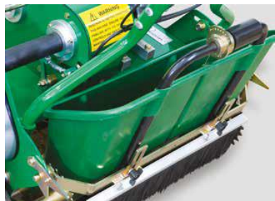
Cepillo de alta densidad y caja de semillas de servicio pesado
