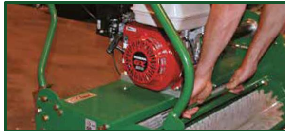
Baje el cassette sobre la barra de amarre trasera y deslícelo por ella
