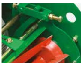
Fácil ajuste de la hoja de la parte inferior al cilindro con una sola llave
