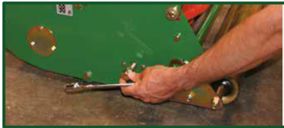
Afloje el perno de retención y deslícelo a través del casete
